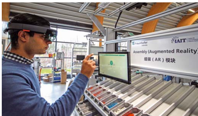
Montage mit Augmented-Reality-Methoden: Die Brille führt reale und digitale Bilder zusammen, um den Arbeiter zielgerichtet zu unterstützen.
